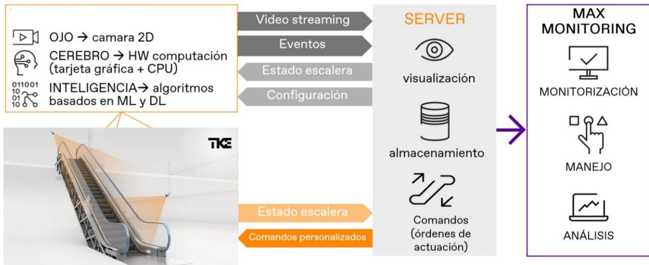
Figura 6. Esquema de la solución propuesta
